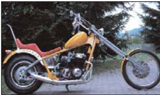
AME SB 702 • CB 750 K6 • Steuerkopf 45°
