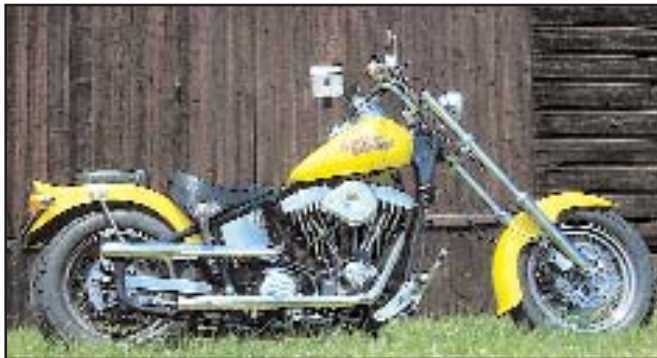
AME ST 800 • HD 1340 Evo • Steuerkopf 37°
