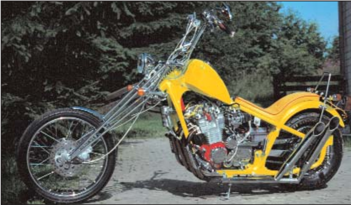
AME ST 802 • YAMAHA FJ 1200 • STEUERKOPF 45° • TRAPEZGABEL
